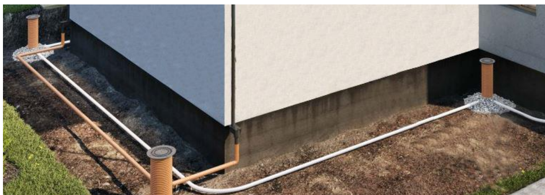
Rys. 2. Schemat instalacji odwadniającej - przekrój poziomy
